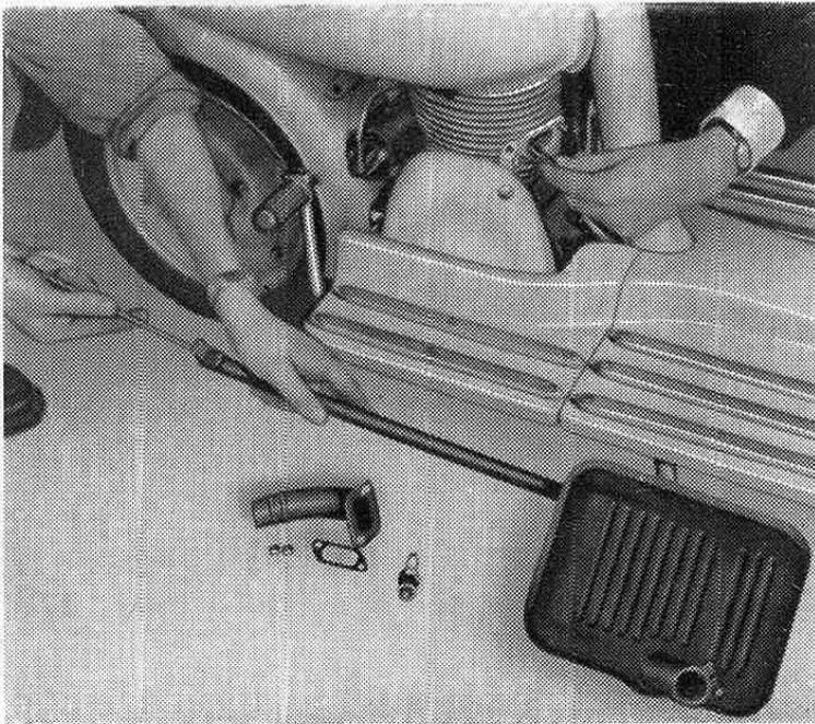
après avoir démonté la tubulure d'essence, de déposer le réservoir fixé au cadre par un écrou et deux boulons en **1**, **2** et **3** et de démonter à l'aide de clés à tube les 3 goujons et les 3 écrous de fixation de la culasse.
