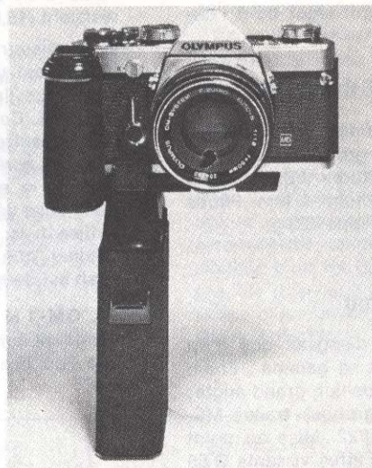
Olympus OM-1 MD équipé du moteur 1 et de la poignée revolver d'alimentation M-18 V
