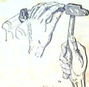
Fig. 6 Règlage de l'entr. électrodes de bougie
