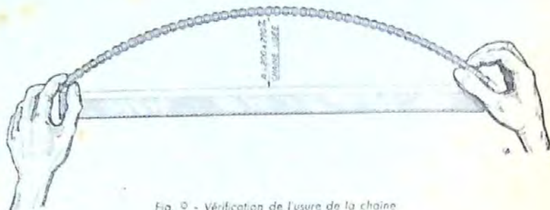
Fig. 9 - Vérification de l'usure de la chaîne
