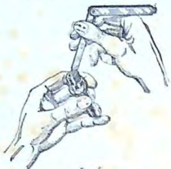
Fig. 5 Vérification de l'entr. électrodes de bougie
