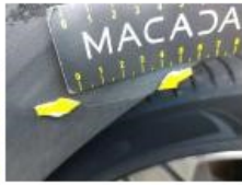
Moulure d'aile AVD, Griffe(s), Réparer/remplacer (montant forfaitaire)
