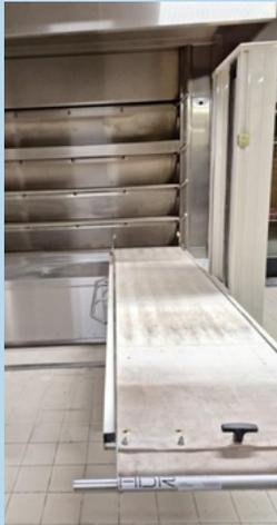
le bonheur de nos boulangers. Ce four a des caractéristiques spécifiques : il est bi énergie, avec 3 étages fonctionnant au gaz et le dernier à l'électricité. Dans la journée, nous fonctionnons seulement avec l'étage électrique pour des économies d'énergie. La cuisson est plus rapide et il peut accueillir 50% de plus de produits à chaque rotation. Gain de temps et d'énergie !
