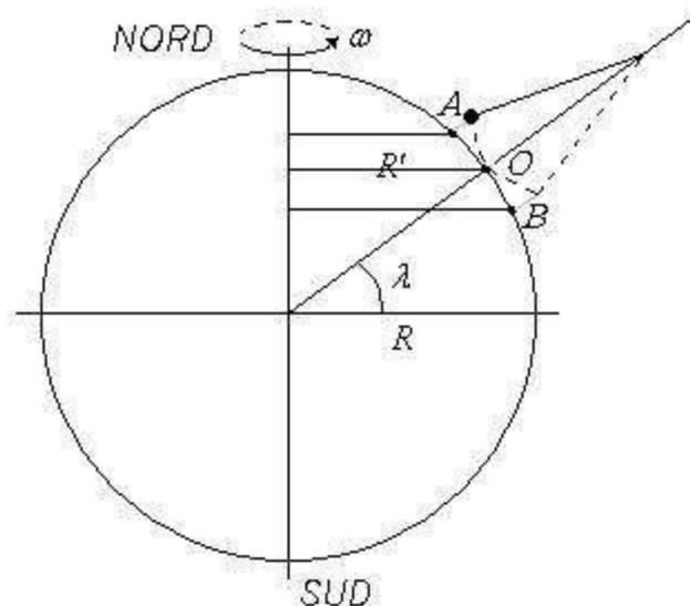
Plaçons-nous à la surface de la Terre au point O sur le schéma : nous avons l'impression d'être immobiles mais en réalité nous tournons d'Ouest en Est autour de l'axe de rotation de la Terre, entraînés par celle-ci. Dans le référentiel géocentrique (lié au centre de la Terre), notre **vitesse angulaire** (en rad/s) est la même où que nous nous placions, mais notre **vitesse linéaire** (en m/s) dépend de la distance qui nous sépare de l'axe de rotation de la Terre, axe Nord-Sud.
