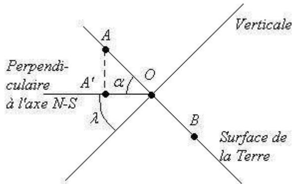
Calculons maintenant les vitesses des points A et B, projetés sur la surface de la Terre des points extrêmes correspondant à l'amplitude des oscillations du pendule. On considère cette amplitude constante, et on considère comme plan le mouvement du pendule : la distance OA ou OB vaut donc L. Par trigonométrie, on trouve que la distance OA', avec A' projeté orthogonal de A sur la perpendiculaire à l'axe N-S passant par O, vaut :
