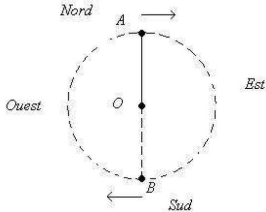
Lâchons le pendule selon la direction Nord-Sud, il oscille au début selon cette direction mais son axe d'oscillations va se décaler progressivement et faire un tour complet. En effet, le pendule, lorsqu'il est lancé à partir du point O, possède une vitesse  $V_0$  dans le référentiel géocentrique. Arrivant à hauteur du point A, comme  $V_0$  est supérieure à  $V_a$ , le pendule aura, par rapport à un observateur fixe au point A, une certaine vitesse  $V$  vers l'Est :
