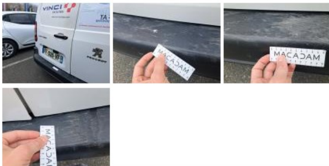
Coin pare-choc ARG, Déformé / Forcé, LI - Réparer et peindre (complet)
