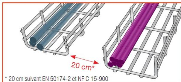
Réaliser le croisement entre les câbles de données et les câbles de puissance à angle droit.
