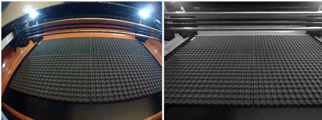
Un résultat mal calibré présentera toujours une distorsion de la lentille, et peut présenter d'autres artefacts, comme le "tremblement" que l'on voit dans la partie inférieure gauche de l'image grise ci-dessous :
