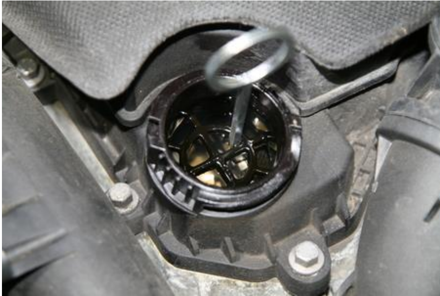
Vue du gabarit de contrôle de la largeur de la courroie en place. Crédit: Image © Challenges — Eric Bergerolle
