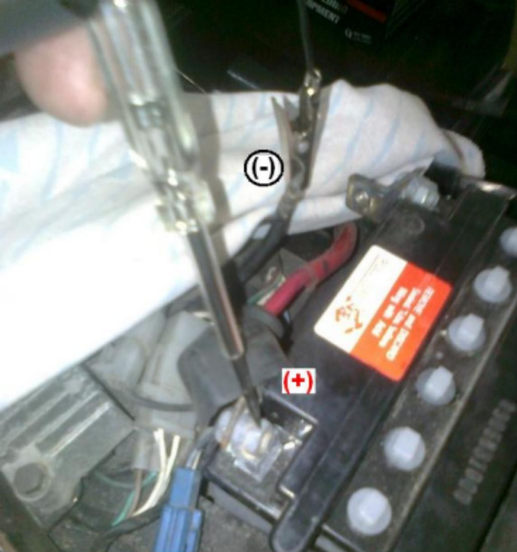
Je connecte ma lampe de contrôle au câble (-) et à la borne (+) de la batterie.
