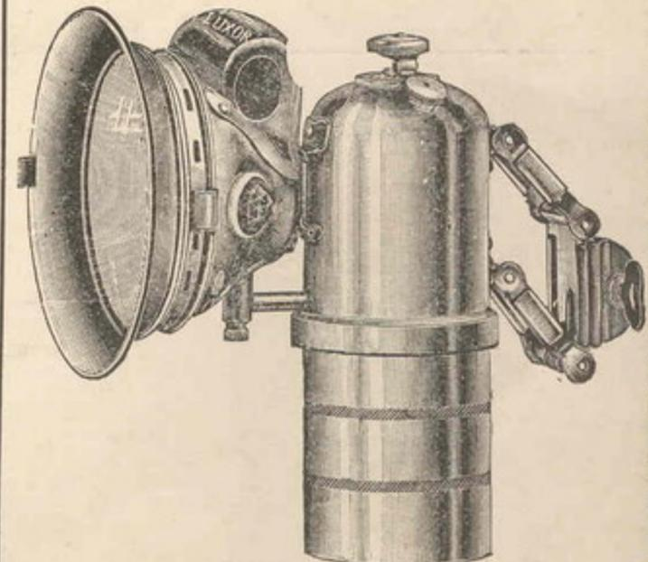
N° 3410. Lanterne Luxor N° 455, lanterne renforcée, cylindrique, réservoir à carbure de grande contenance avec bague filetée en fondu vissant sur le corps, réflecteur de 96 mm.
