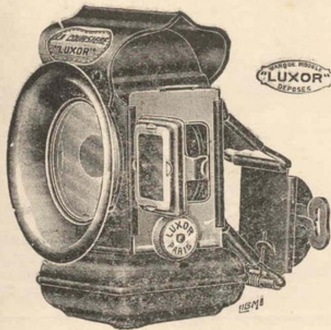
N° 3457. **Lanterne à huile La Coursière**, suspension arrière glissière de côté et porte ouvrante, réflecteur cuivre nickelé, diamètre 82 mm., verre démontable 46 mm., porte-mèche à baïonnette émaillée, demi-nickelée. . . . . Prix : 9 60
