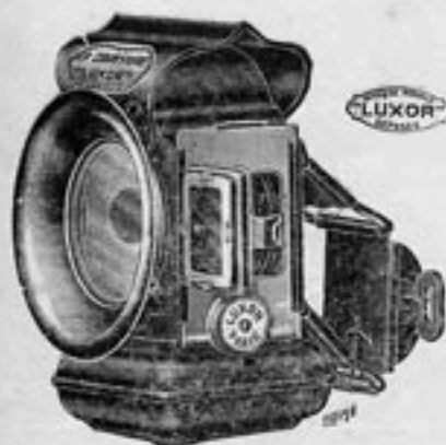
N° 3457. Lanterne à huile La Coursière , suspension arrière glissière de côté et porte ouvrante, réflecteur cuivre nickelé, diamètre 82 mm., verre démontable 46 mm., porte-mèche à batonnette émaillée, demi-nickelée. .... Prix : 9 60
