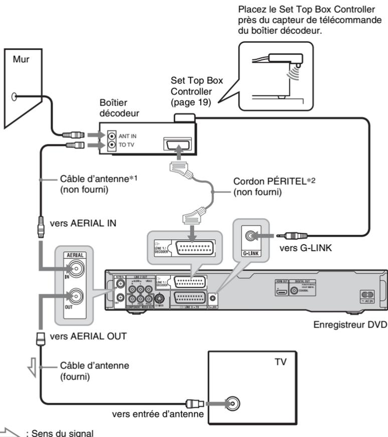
\*1 Si votre boîtier décodeur ne comporte pas de prise de sortie d'antenne, raccordez le câble d'antenne à la prise AERIAL IN de l'enregistreur.
