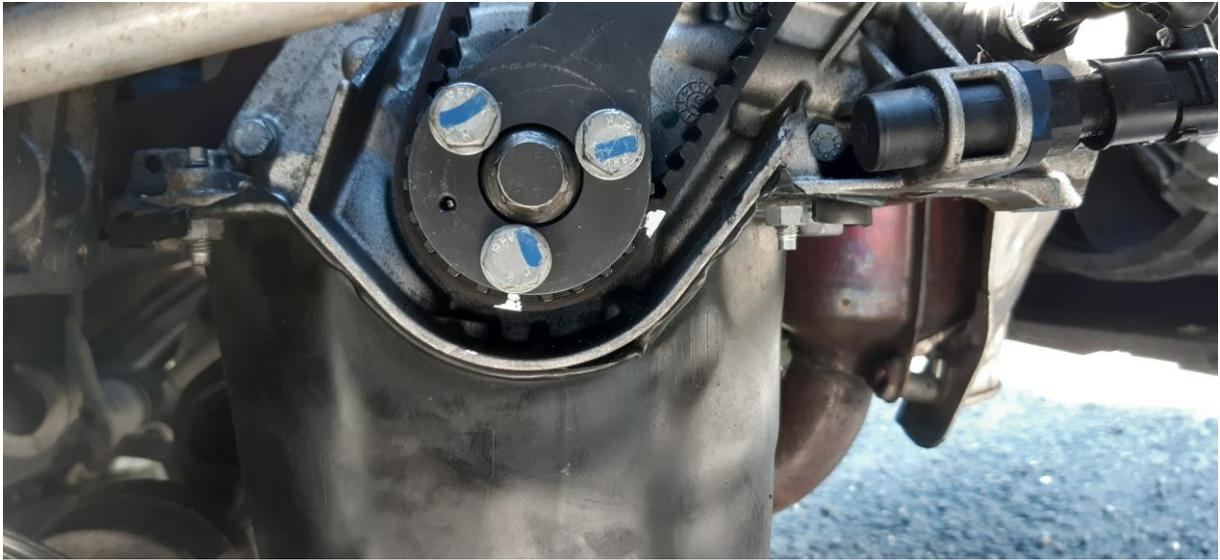
Ensuite, noter la position de la poulie tendeur et démonter la courroie, ainsi que la pompe à eau. Nettoyer le bloc-moteur et ne pas oublier de mettre un récipient en dessous pour le liquide de refroidissement.
