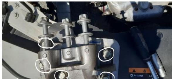
Démonter les caches, démonte la poulie damper ainsi que la courroie d'accessoires. Il ne faut pas oublier de noter le schéma de montage de la courroie avant le démontage.
