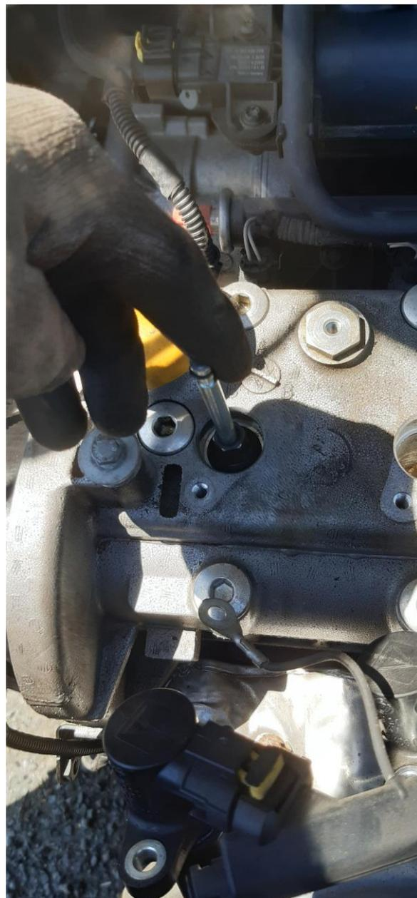
Avec une multiprise, dévisser le bouchon. Normalement, il faudrait démonter la pièce 1, mais je l'ai bloquée avec une clé Allen coudée. J'avais la flemme (voir vidéo)
