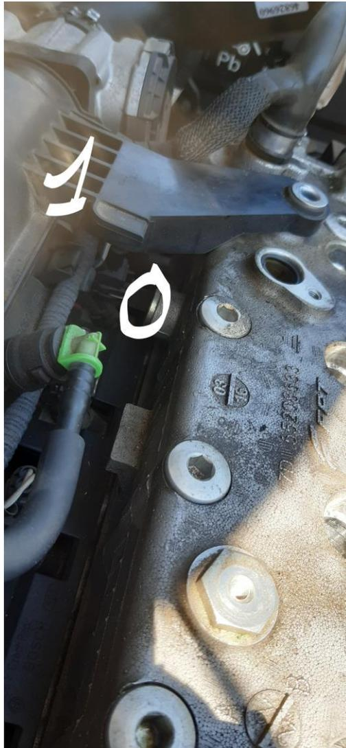
Bloquer la poulie du bas avec la pièce fournie par le kit. Il y a un détrompeur.
