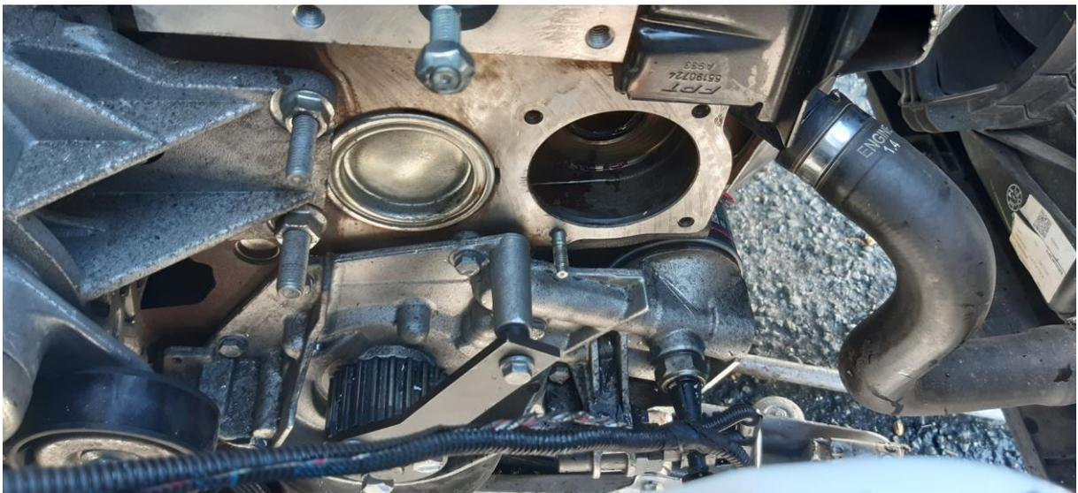
Utiliser le nouveau kit et le joint bleu pour installer la nouvelle pompe à eau,
