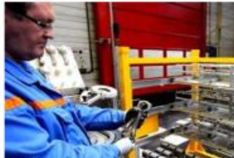
2011 : Bielles Production des premières bielles EB sur la ligne D44 du Bâtiment 5. Début des démarches RUI et SMED sur la ligne.
