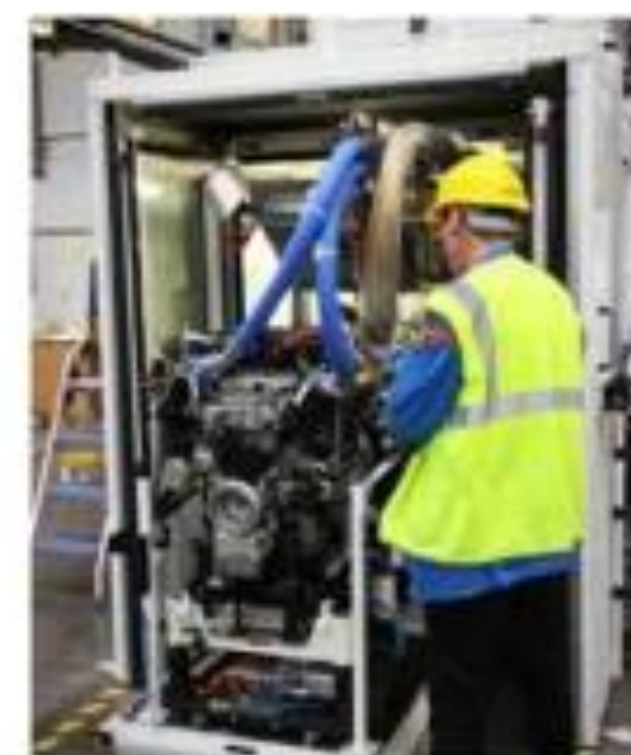
2013 : contrôle au banc en ligne 100% des process produits en ligne sont contrôlés sur les bancs à chaud en charge.
