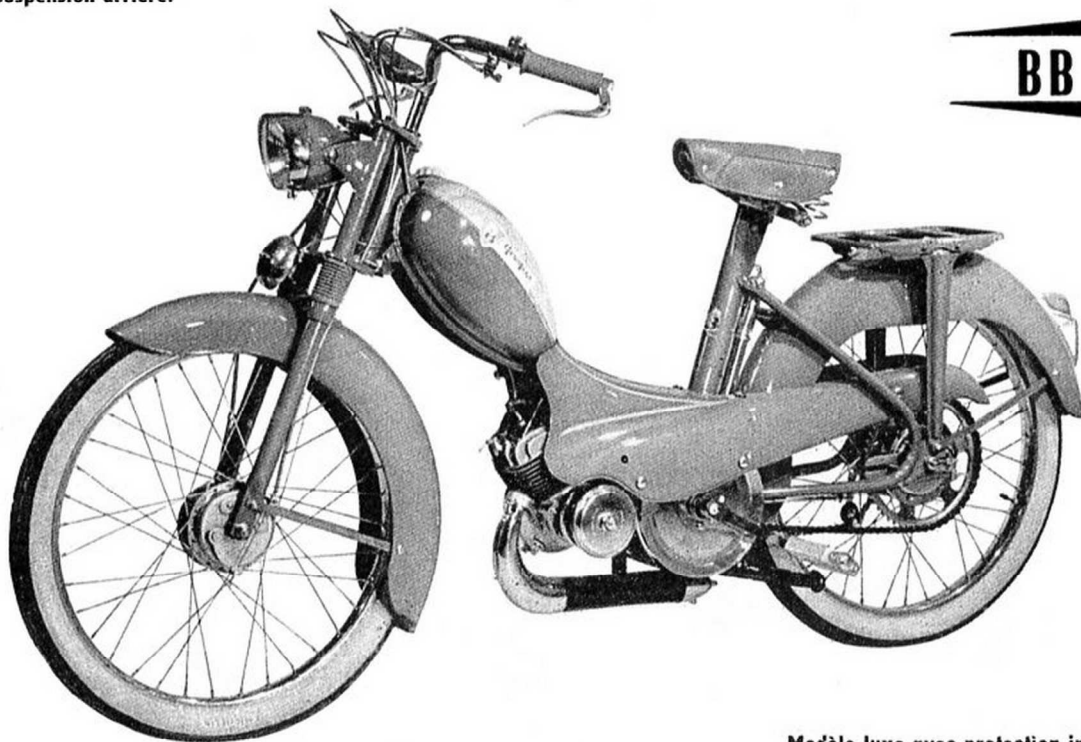
Modèle luxe avec protection intégrale par carénage et garde-boue à emboutis profonds.
