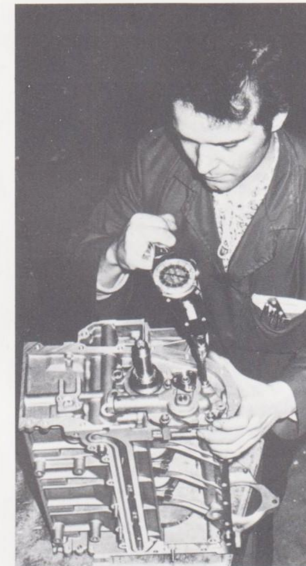
Supercontrôle : un couple de serrage est toujours très important. M. Maurice Martel est ici en train de vérifier, à l'Assemblage, celui d'une pompe à huile.
