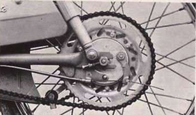
▲ Le frein arrière de 100 mm est excellent. Par contre... Le moyeu n'est pas à broche.
