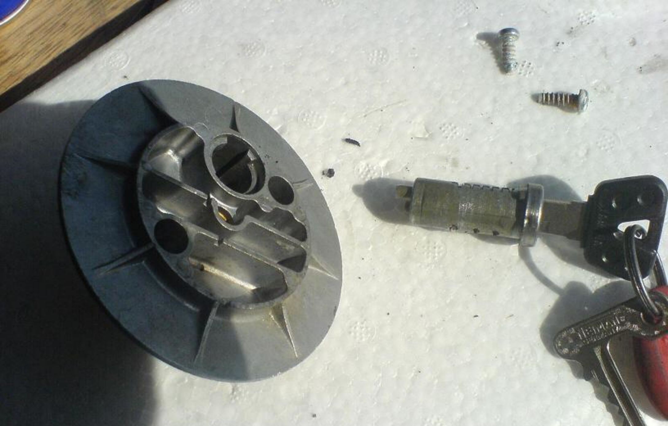
Démontage de la garniture, extraire le barillet clef en position ouverture
