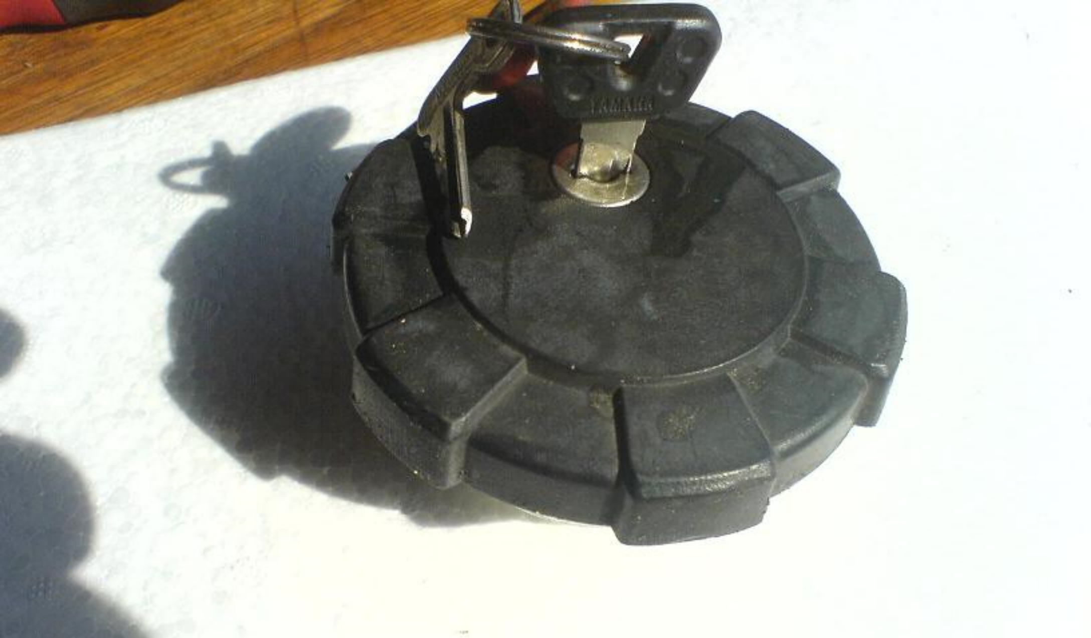
Démontage serrure bouchon réservoir essence TW 125
