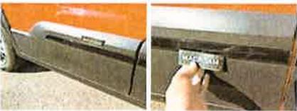
Protect. pass. roue AVG, Dégrafé, Dépose/Répose
