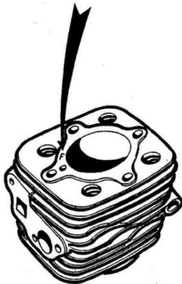
Emplacement du repère sur le cylindre
