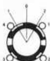
Fig. 1 - Commutatore a 3 posizioni  $\varnothing$  32x35 mm. - corpo in plastica nera - ghiera cromata - chiave ammortizzata con rivestimento isolante - foro per il fissaggio  $\varnothing$  22,5 mm. - 4 prese di corrente ad innesti faston da 4,8x0,5 mm.
