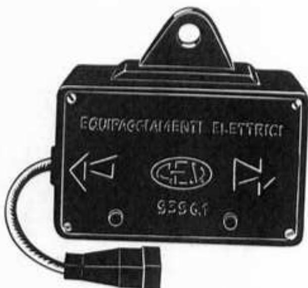
Regolatore di tensione elettronico 75x118x52 - scatola e coperchio neri in materiale plastico - supporto in gomma antivibrante con foro di fissaggio per vite da M8 - circuito stampato con componenti « Solid State » per raddrizzamento corrente e regolazione automatica di carica con dispositivo Flash per batteria a 6V - cavetto con 9 prese di corrente ad innesti maschi da Ø 2,3 montati su blocchetto volante con cappuccio di protezione.
