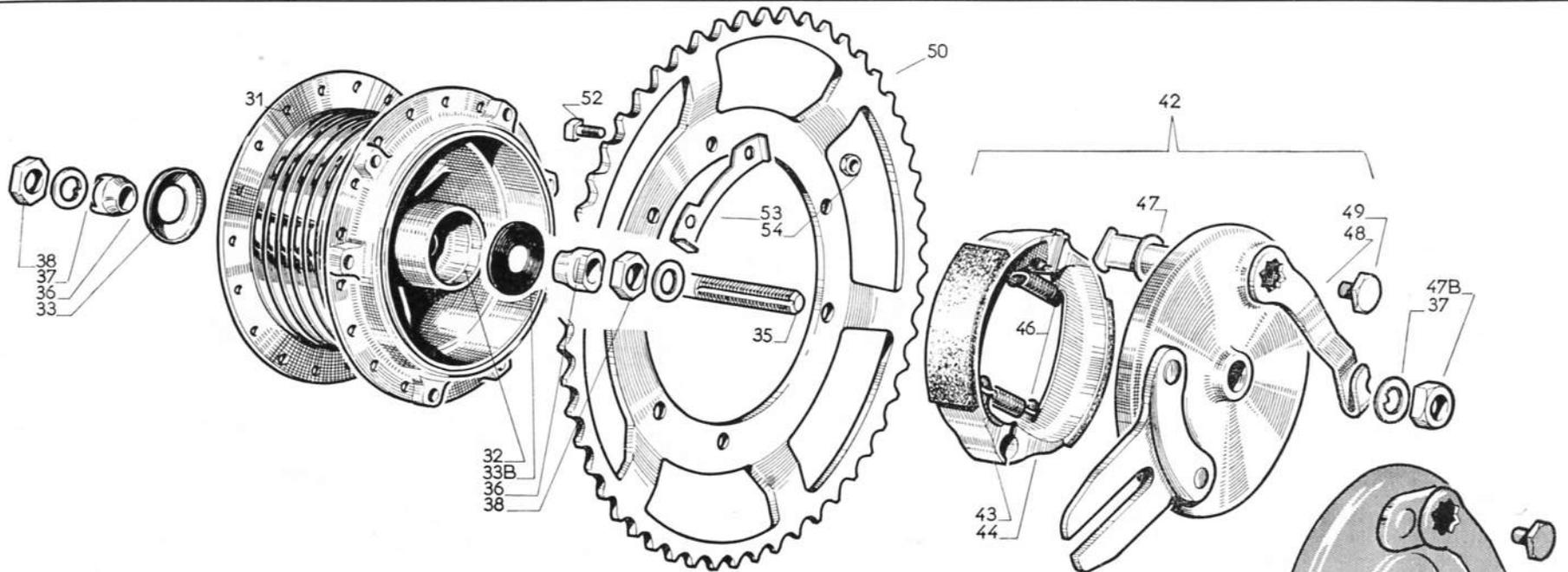
Le plateau de frein N° 42 B est interchangeable avec le N° 42 à condition de placer sous le plateau 2 écrous V 1442  $\varnothing = 11$  de 16 sur plats, épaisseur = 5.
