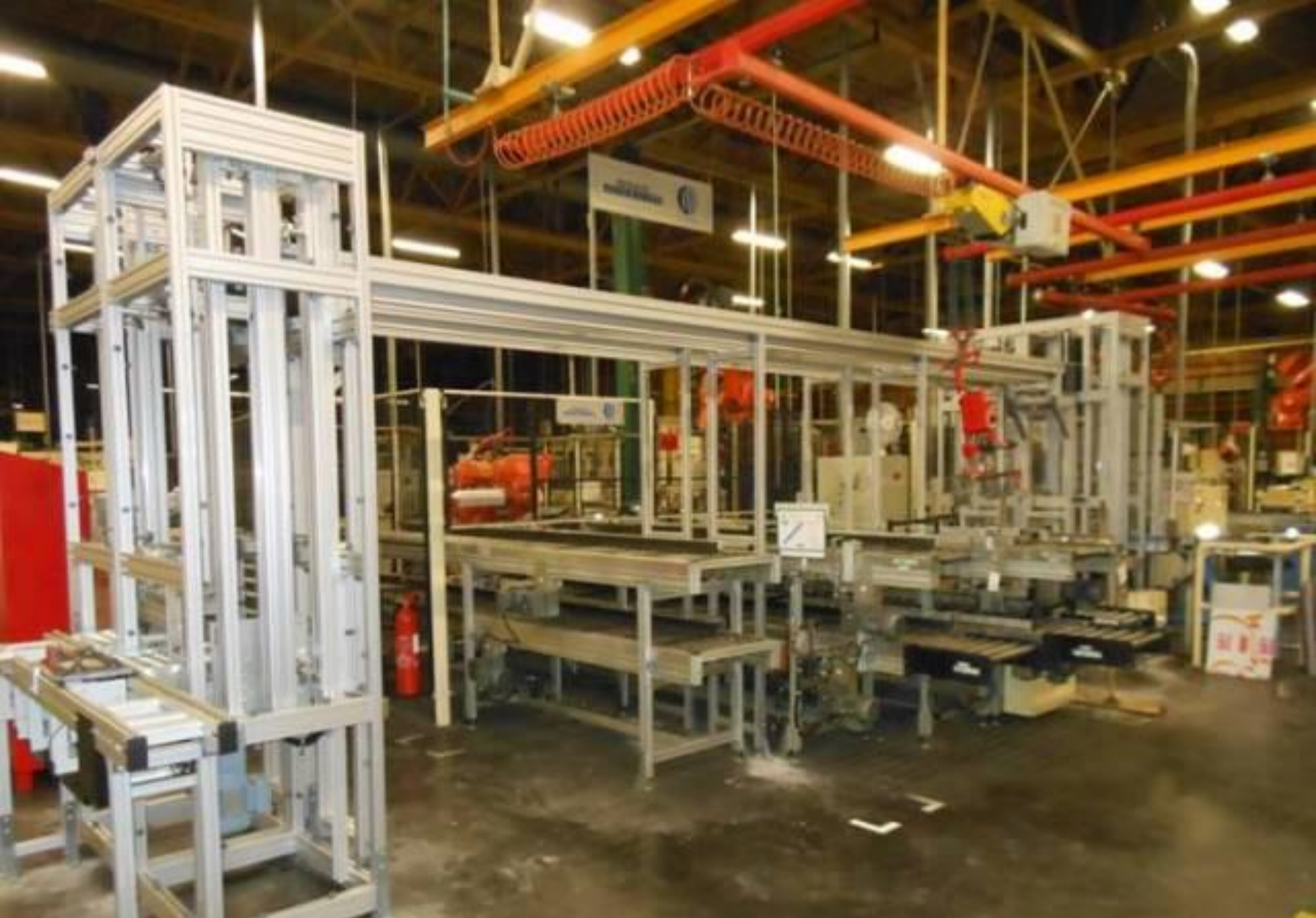
Assemblage moteur D : Ajout d'un convoyeur/ascenseur pour suppression encyclage culasses
