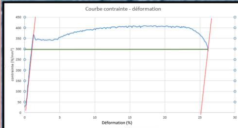
Courbe contrainte déformation de l'éprouvette sans défauts
