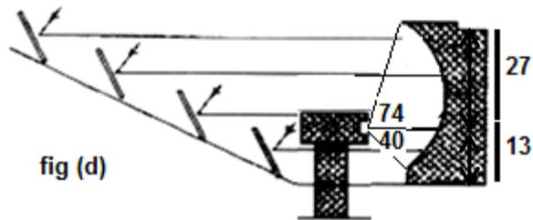
Ce paraboloïde fait converger au foyer des rayons solaires réfléchis par 63 héliostats plans de  $45 \text{ m}^2$  chacun fig. (c). L'implantation des héliostats par rapport au paraboloïde est donnée par le schéma de la fig. (d).
