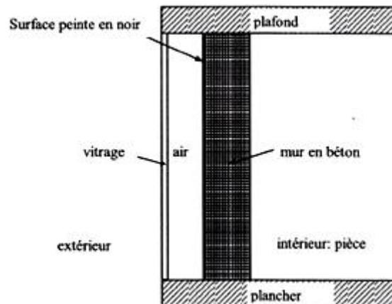
La coupe latérale d'un mur capteur à l'allure suivante (sans souci d'échelle):
