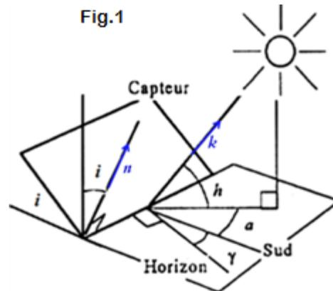
8. A 9h TSV, avec quel angle d'incidence le rayonnement direct éclaire-t-il le pan Est du toit qui forme un angle de 40° avec le plan horizontal, le faîte du toit étant dans la direction N-S.
