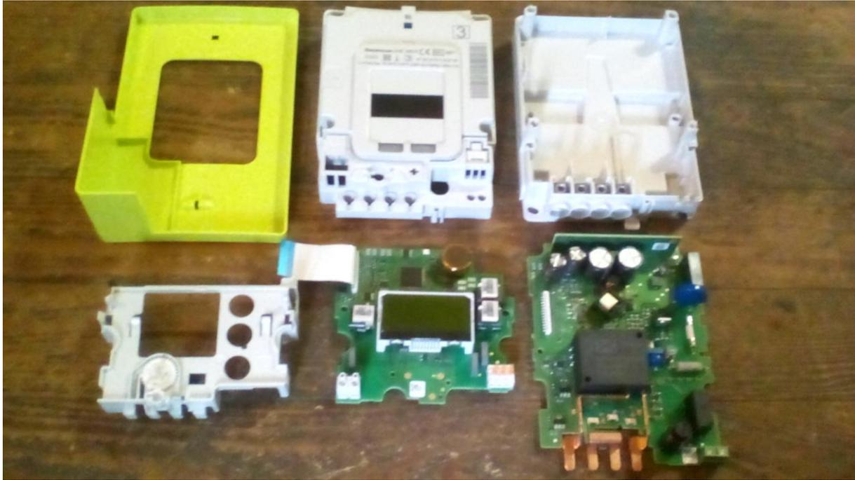
La masse de tout le circuit basse tension est mis à la Phase entrante (avant shunt et breaker).
