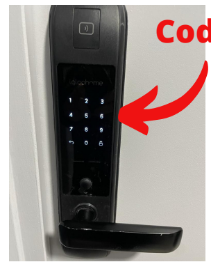
To enter the code that you must have received by email beforehand, simply put your hand in front of the numbers, they will light up automatically/ Pour saisir le code que vous avez dû recevoir par email au préalable, il vous suffit de passer votre main devant les chiffres et appuyer sur # ou le cadenas, ils s' allumeront automatiquement.
