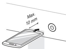
**3** Tenere premuto il pulsante **Temp.** per 3 o più secondi mentre si tiene il microfono dello smartphone sul tasto **Accensione** fino al completamento del trasferimento dati.
