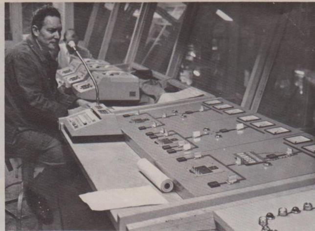
Trois images caractéristiques de la fonderie : la cabine de fusion, qui domine l'ensemble des ateliers (ci-contre à gauche), le portique mobile, connu sous le nom de « dahut », qui permet d'amener les matières premières à une hauteur de 12 m (en cours de montage ci-dessous), et une benne de chargement, d'une capacité de trois tonnes, arrivant près d'un four de fusion (ci-contre à droite).
