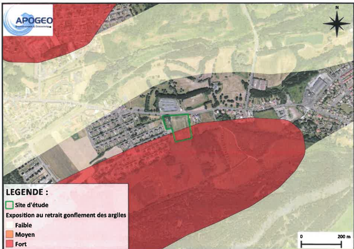
Figure 4 : Aléa retrait gonflement des argiles - GEORISQUES
