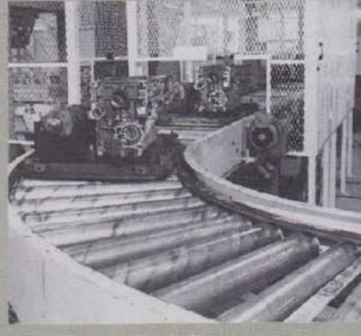
carter-cylindres (ph. 2) ou du volant, sont constituées de toute une série de postes d'usinage en ligne, où les pièces sont transférées au fur et à mesure, avec la possibilité de les identifier pour usinage correspondant ;
