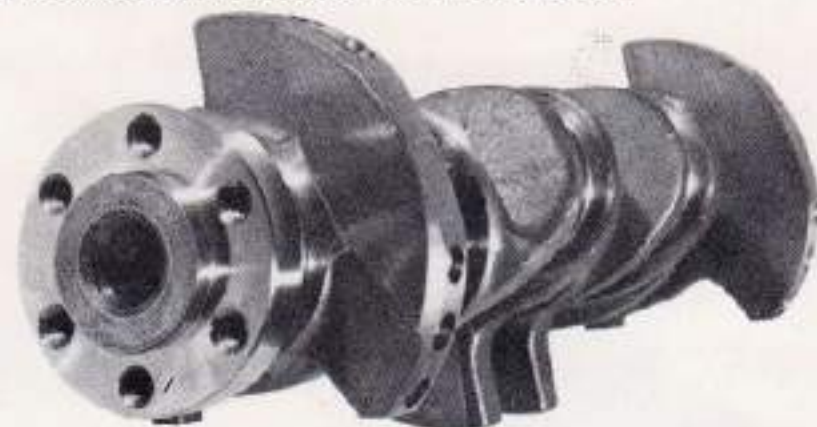
Le vilebrequin est en fonte à graphite sphéroïdal.
