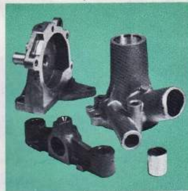
Huit des vingt pièces usinées à la Française de Mécanique : le support (en haut à gauche) et le corps (en haut à droite) de pompe à eau, le support d'axe de culbuteurs (en bas à gauche) et la bague de centrage d'embrayage...
