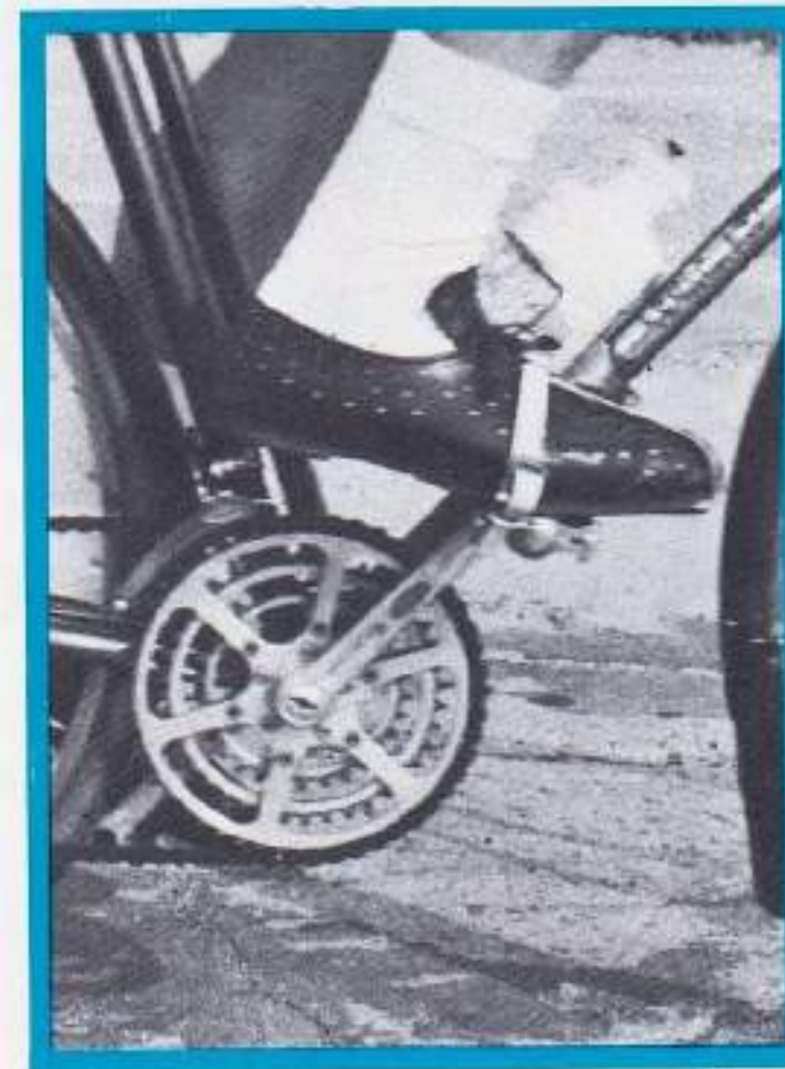
Comme le fait le moteur pour permettre le déplacement de la voiture, le cycliste, pour avancer, transforme un mouvement rectiligne en mouvement circulaire. C'est sa jambe qui fait office de piston et de bielle et c'est le plateau de la bicyclette qui joue le rôle de vilebrequin.
