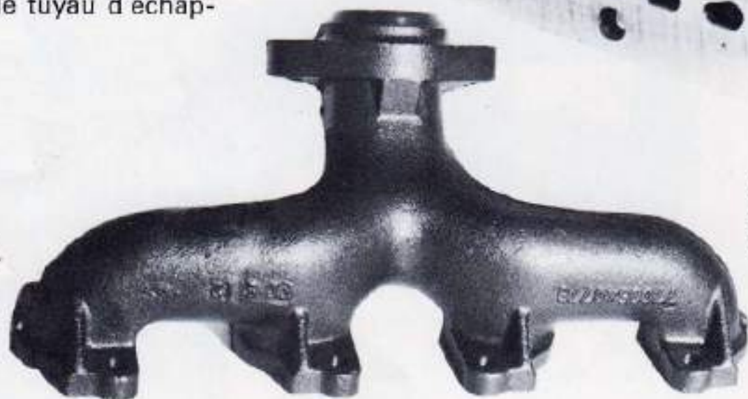
La tubulure d'échappement vient se fixer sur la culasse.
