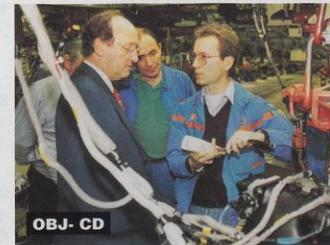
**Bernard Lefebvre et Jacques Mette (Assemblage TU)**, pour gagner du temps et éviter la détérioration des connecteurs lors de l'essai-moteur aux bancs, ont eu l'idée d'uniformiser le connecteur sur les faisceaux, ce qui permet d'accepter toutes les variantes.
