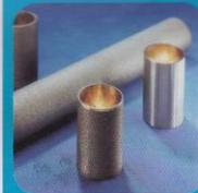
Nouvelle fabrication en Fonderie, celle des chemises N : une collaboration étroite avec l'Usinage du Département Moteur J
