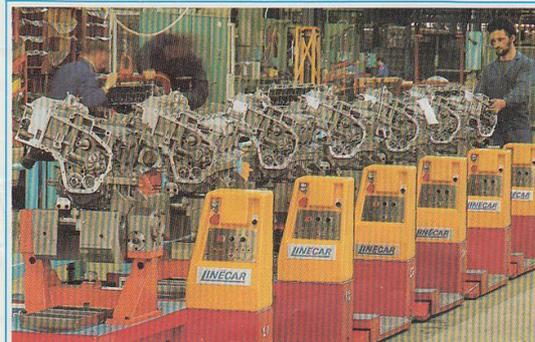
La première Unité de Montage X étant arrivée à saturation, on entreprend en 1977 la construction et l'installation d'une deuxième Unité équipée de chariots filoguidés (ph. 7) : il s'agit là d'une première à l'échelle industrielle.
