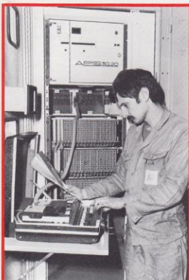
C. Vanoverschelde, Dépanneur au J, interroge un "gouverneur programmable" pour rechercher l'origine d'une panne.
