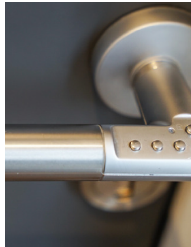
Enter the code 412312 once it is validated, a green light flashes and you can open the door. To close it, press the button next to the light. When it turns red, the door is closed/Faites le code 412312 une fois qu'il est validé, un voyant vert clignote et vous pouvez ouvrir la porte. Pour la fermer, il faut appuyer sur le bouton juste à côté du voyant. Lorsqu'il passe au rouge, la porte est fermée.
