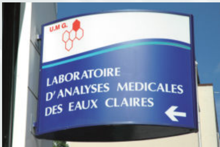
Caisson lumineux double face faces cintrées en Altuglass diffusant, profilés latéraux en aluminium laqué.
