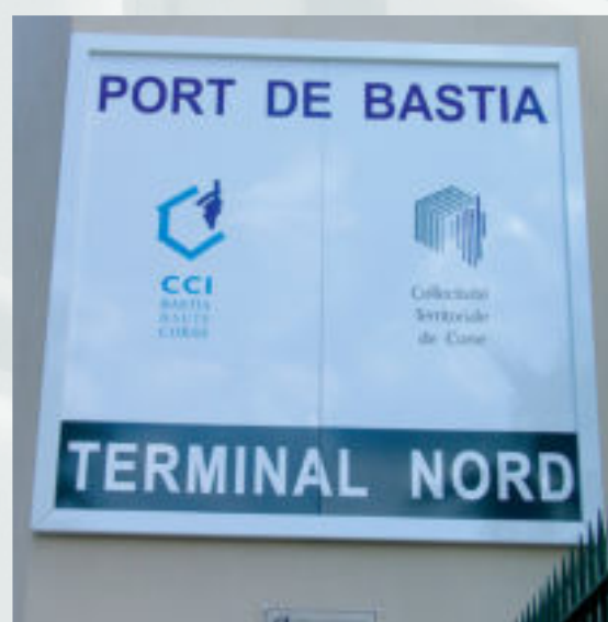
Panneau 4 m 2 en 2 éléments verticaux, pose murale sur lisses. Moulure de finition.
