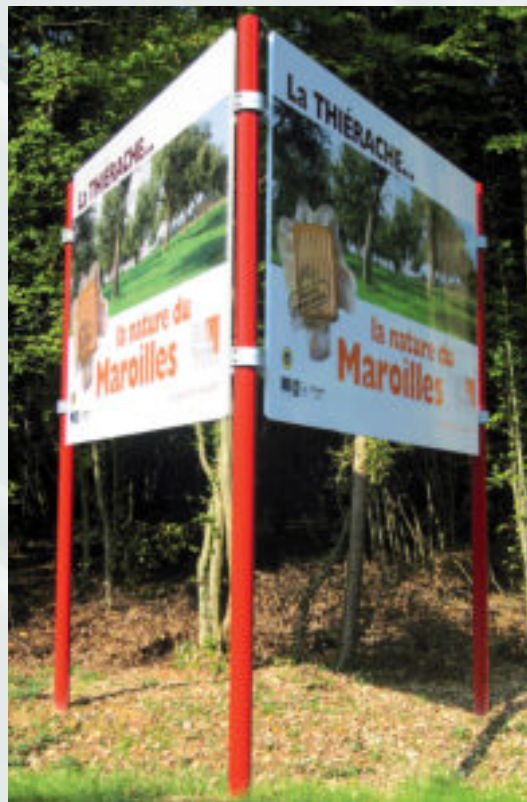
Panneau 8m 2 en 4 éléments verticaux pose en V sur 3 poteaux acier galvanisé diamètre 140 mm avec colliers coquille.
