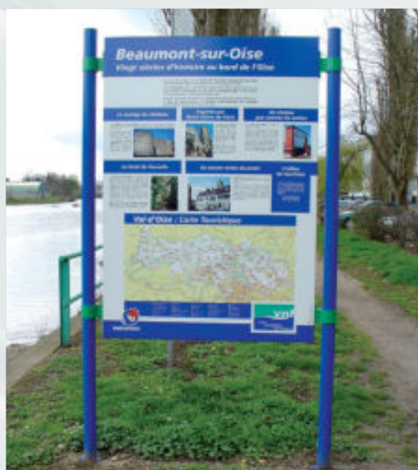
Panneau double face Pose en bi-mâts sur 2 poteaux aluminium diamètre 90 mm avec colliers coquille.
