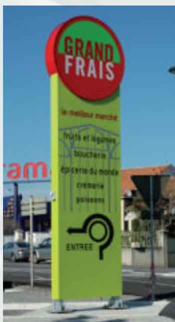
Totem faces planes dimensions 1800 x 6000mm. Logo lumineux rétroéclairé par LED.
