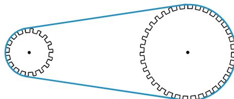
c. Sur le pignon est fixée la roue arrière et sur le plateau sont fixées les pédales.
