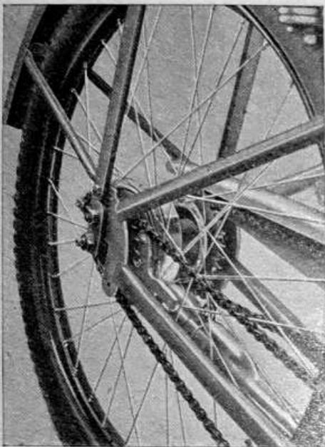
Fig. 16: Moyeu Tambour HR 115 à roue libre et frein par contre-pédalage
