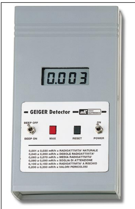
Figure 2 : Sur la partie supérieure du boîtier nous avons reproduit un tableau avec les valeurs de dangerosité en milliroentgen/heure. Le poussoir de gauche permet de connaître la valeur maximale de la radioactivité mesurée durant la journée et celui de droite sert à la remise à zéro des valeurs mémorisées.
