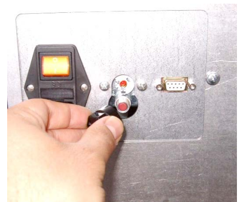
Fig. 24 - Bouton de réarmement de la sonde à boule
