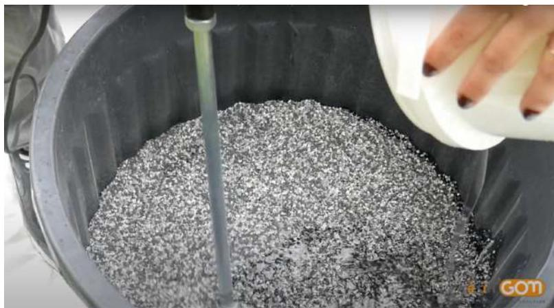
**4.4** Mélangez la résine et la gomme à l'aide du malaxeur pendant 5min, jusqu'à l'obtention d'un mélange homogène.
