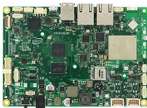
SBC-C61 Module au format 3.5" avec processeur NXP iMX8M
