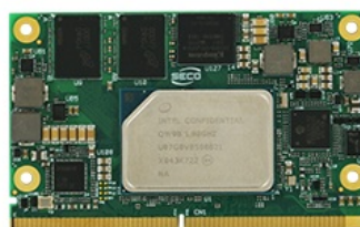
SM-C93 Module SMARC Rel 2.1.1 avec processeurs Intel, Atom (Série x6000E), Pentium et Celeron série N & J pour applications Safety
