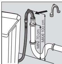
Montez la crose sur le tuyau de vidange. Placez l'ensemble dans un conduit de vidange (ou dans un lavabo) à une hauteur comprise entre 70 et 100 cm. Veillez à ce qu'il ne risque pas de tomber. Il est indispensable de prévoir une entrée d'air à l'extrémité du tuyau de vidange, pour éviter tout siphonnage éventuel.
