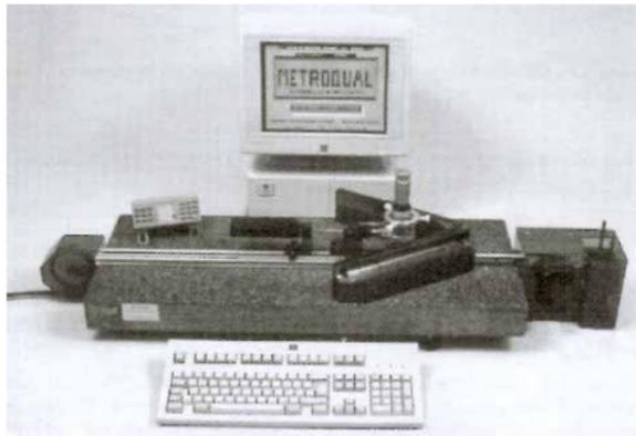
Ce banc de mesure spécifique est une réalisation unique dans son principe, il simule une bague parfaite par trois plans tangents, deux fixes constitués par deux règles en vé, un troisième mobile, appliquant un effort compatible avec l'instrument et mesurant le déplacement pour définir le diamètre conventionnellement vrai, avec une résolution de 0,1  $\mu\text{m}$ .
