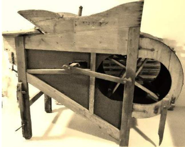
*Il fallait pour cela tourner la manivelle (qui est de l'autre côté de l'image) d'une façon régulière et à la vitesse juste convenable, car une accélération brutale éjectait le grain avec les déchets, et trop de lenteur le nettoyait mal, et le travail n'avancait pas. C'était facile, long, et ennuyeux. C'était le travail que je pouvais faire, mon père se contentant pour sa part d'alimenter la trémie et de récupérer le grain propre au fur et à mesure de la production.*
