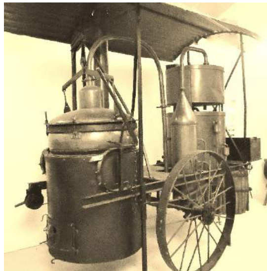
Alambic itinérant utilisé dans les campagnes pour la fabrication de la goute Salle des Machines agricoles du Vieux Cormenier, Chez Bernardeau 86 CHAMPNIERS
